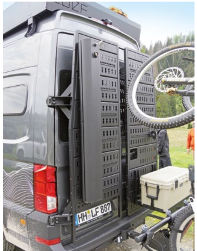
Viel self-made by LOEF mit Anbaukomponenten by Yakima: Dachträger, Dachterrasse, Heckträger, Fahrradträger. Es gibt wenig, das nicht möglich ist – und das Gewicht spielt in der Klasse keine große Rolle mehr.
