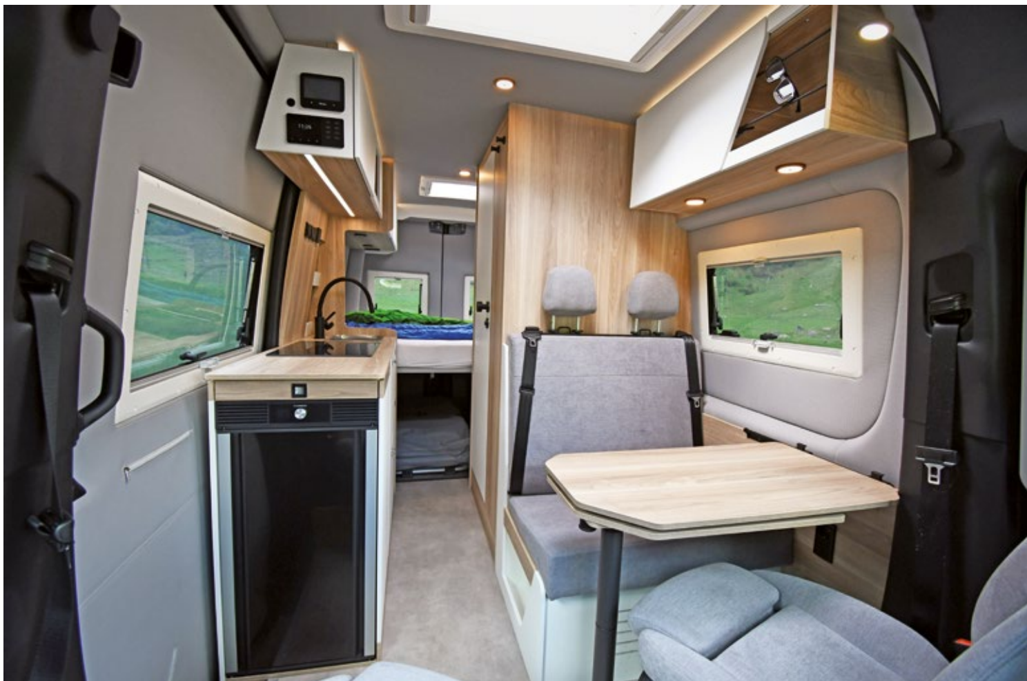
Das Fenster an der Sitzgruppe ist vergleichsweise klein. Truma iNet X-Panel und der Batteriecomputer von Simarine liefern detaillierte Informationen, zum Beispiel über die Ladestände.
