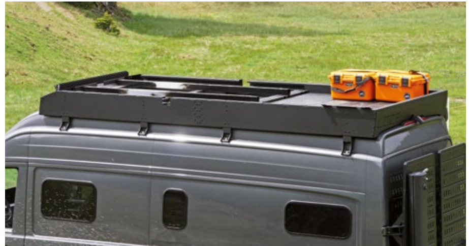
Viel self-made by LOEF mit Anbaukomponenten by Yakima: Dachträger, Dachterrasse, Heckträger, Fahrradträger. Es gibt wenig, das nicht möglich ist – und das Gewicht spielt in der Klasse keine große Rolle mehr.
