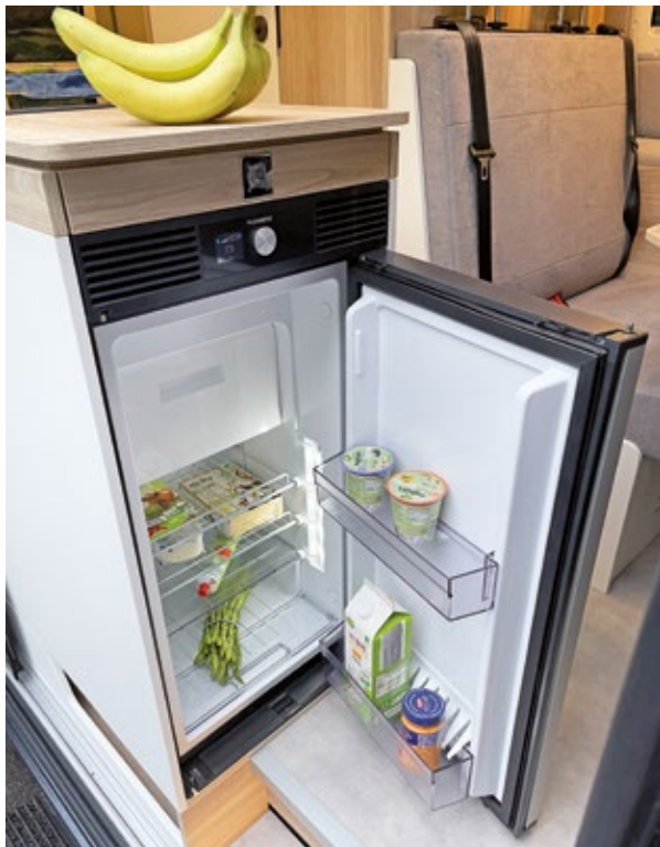
Gern gesehen: der Dometic-Kühlschrank mit doppeltem Tür-Anschlag und Dreh-Drück-Steller. Letzterer lässt sich einfach besser bedienen als ein Touchscreen.
