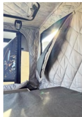
Die Echtglas-Luke mit 90 mal 45 Zentimetern sorgt für Licht und bequemen Ausstieg. Thermomatten und Fenster für perfektes Klima im Sommer wie Winter.
