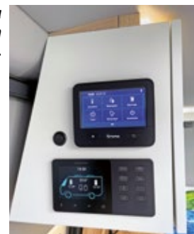
Das Fenster an der Sitzgruppe ist vergleichsweise klein. Truma iNet X-Panel und der Batteriecomputer von Simarine liefern detaillierte Informationen, zum Beispiel über die Ladestände.
